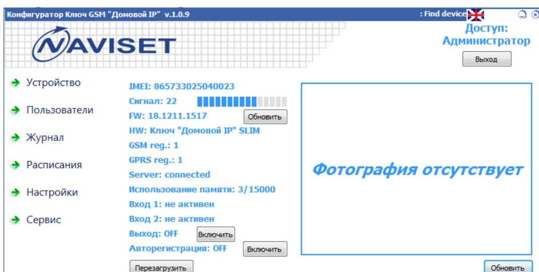
Из данной панели можно осуществлять ручное управление выходом для тестирования работоспособности GSM ключа и подключенных к нему исполнительных устройств.
