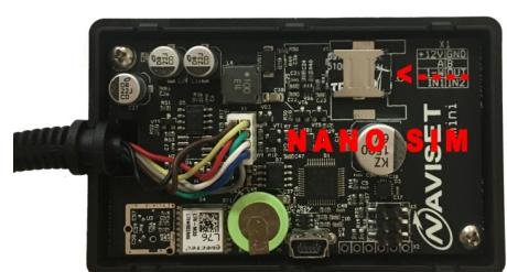
установить SIM карту типоразмера NANO SIM. SIM карта устанавливается контактами вниз, срезом в верх как показано на картинке.
